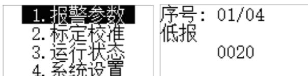
若需要修改报警参数，需长按确认键，进入密码验证界面，输入正确的密码后即可修改报警参数。
