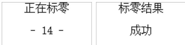
**警告：**零点校准须在洁净的空气中或通入氮气时进行。
