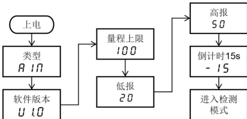
进入正常检测模式，待显示数据稳定后（不同种类气体稳定时间不同，一般为 5-30 分钟），主窗口显示的数据即为当前气体浓度值。上电稳定一个小时后，达到最佳检测状态。
